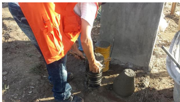
Foto 4: Muestras de cilindros de concreto para ensayos de resistencia
