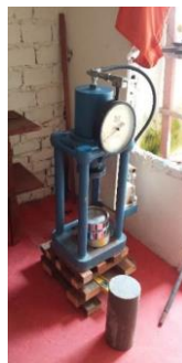
Inspección al ensayo de resistencia a los cilindros de concreto
