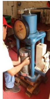
Inspección al ensayo de resistencia a los cilindros de concreto
